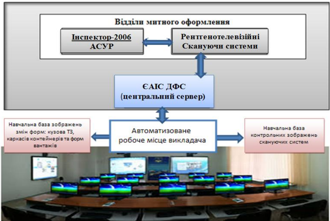
Мал. 1. Модель «Автоматизованого інформаційно – тренувального комплексу забезпечення навчання технологіям аналізу відсканованих зображень об'єктів митного контролю»
